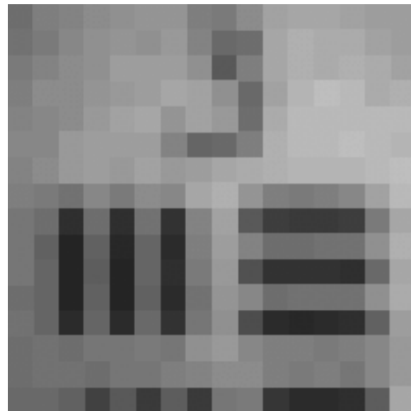
(d) USAF Test Chart Group 3, Element 1 8 line pairs per mm
