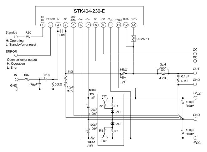
\*1 Metal Plate Cement Resistor 0.22Ω±10%(5W)
