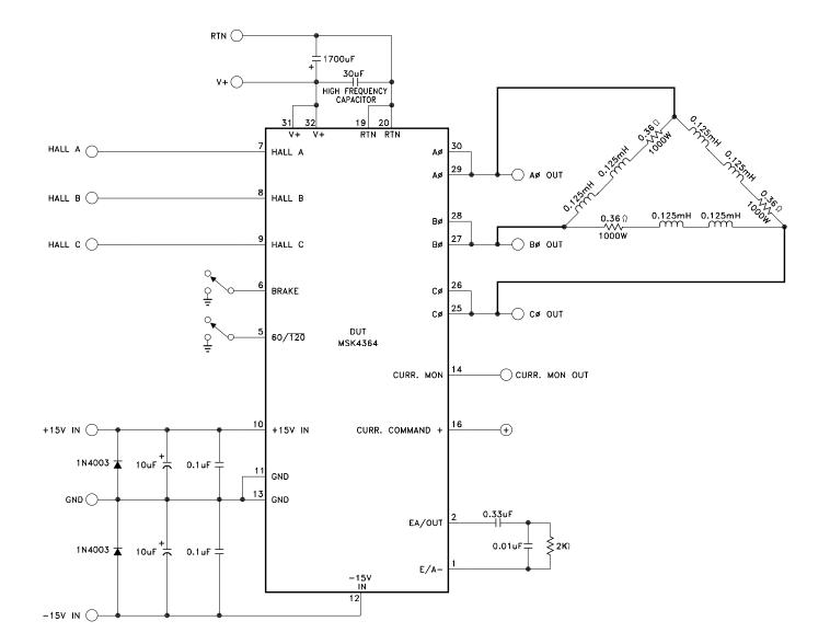
TYPICAL TEST SCHEMATIC
