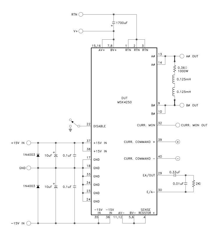
TYPICAL TEST SCHEMATIC
