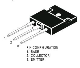
TO BE MOUNTED WITH SILICONE GREASE ON THE BACK SIDE, ENSURING BACK SIDE HOLES FILLED.
