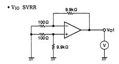
• For  $V_{IO}$   $V_{CC}/V_{EE}=\pm 15V$   $V_{IO}=V_{O}1/100$
