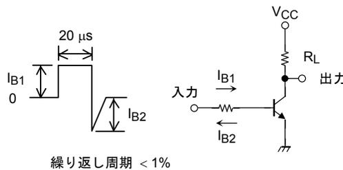
図1 スwitching時間測定回路
