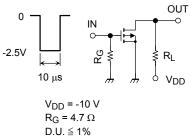
$$\begin{split} &\text{D.U.} \le 1\% \\ &\text{V}_{\text{IN}} : t_{\text{r}}, \, t_{\text{f}} < 5 \text{ ns} \\ &\text{Common Source} \end{split}$$
