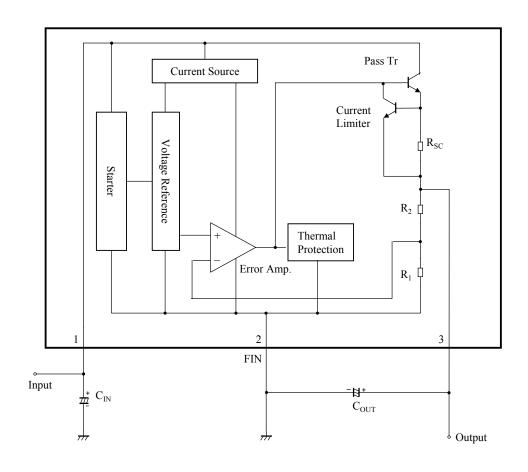
$\begin{array}{c} C_{\rm IN} \! \geq \! 0.33 \; \mu {\rm F} \\ C_{\rm OUT} \! \geq \! 0.1 \; \mu {\rm F} \end{array}$
