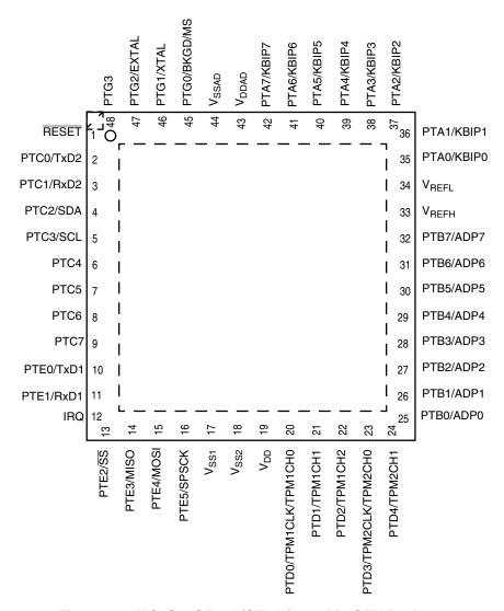
Figure 2-1. MC9S08GT16A/GT8A in 48-Pin QFN Package
