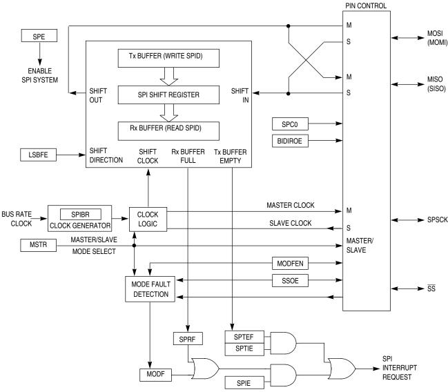
Figure 12-4. SPI Module Block Diagram
