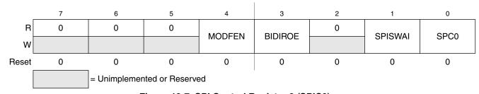
Figure 12-7. SPI Control Register 2 (SPIC2)
