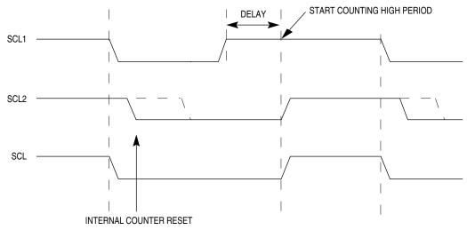
Figure 13-9. IIC Clock Synchronization
