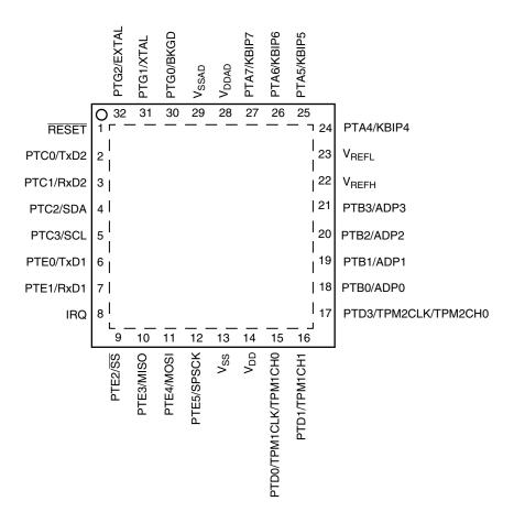
Figure 2-4. MC9S08GT16A/GT8A in 32-Pin QFN Package
