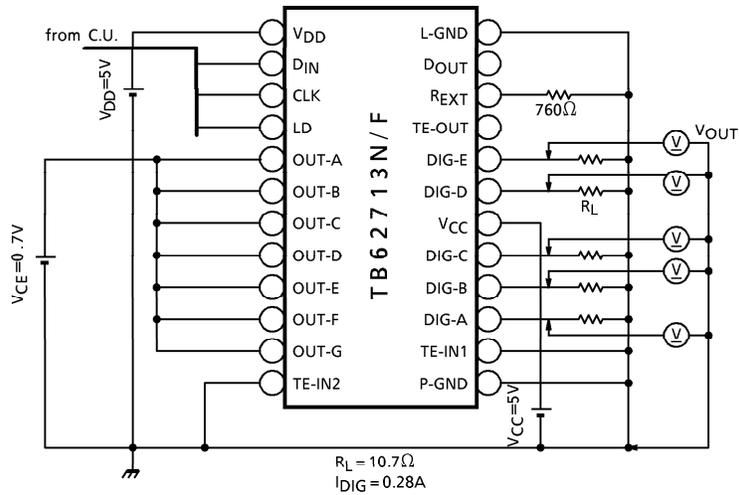
(6)  $I_{DD1}$ ,  $I_{DD2}$ ,  $I_{DD3}$ ,  $V_{OH1}$ ,  $V_{OH2}$ ,  $V_{OL1}$ ,  $V_{OL2}$ ,  $f_{CLK}$
