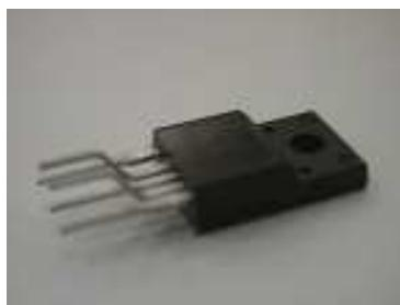
1. Drain 2. GND 3. V<sub>CC</sub> 4. FB 5. Sync
