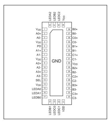
Pin Configuration (42-TQFN ZL, Top-Side View)
