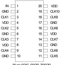
20 pin SOIC, SSOP, TSSOP
