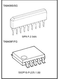
Weight SIP9-P-2.54A: 0.92 g (typ.) SSOP10-P-225-1.00: 0.09 g (typ.)
