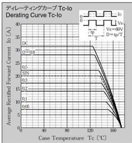
\* Sine waveは50Hzで測定しています。
