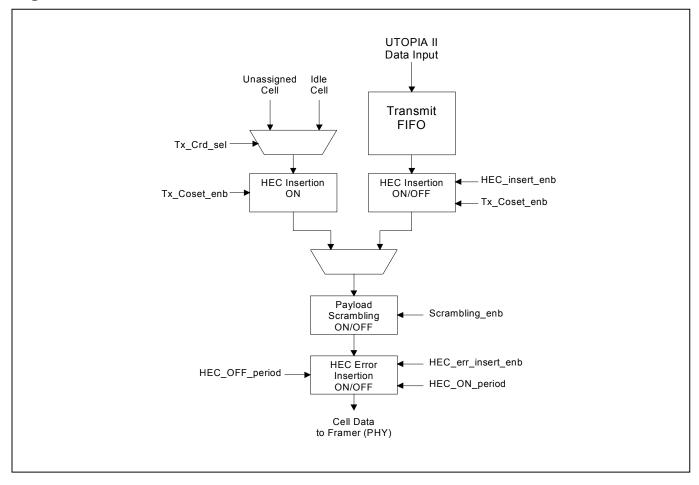
Figure 24-6. Transmit Cell Flow
