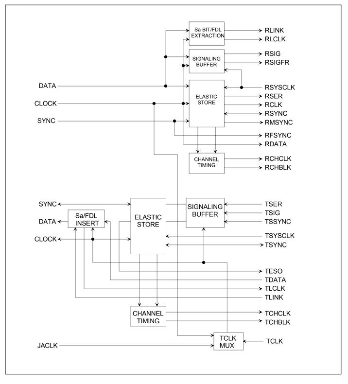
Figure 2-5. Backplane Interface (TDM Backplane Enabled)
