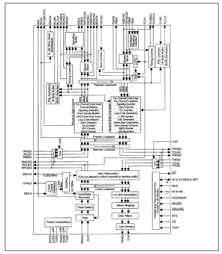
Figure 1-1. DS2152 Enhanced T1 Single-Chip Transceiver
