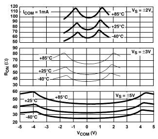
FIGURE 11. ON-RESISTANCE vs SWITCH VOLTAGE
