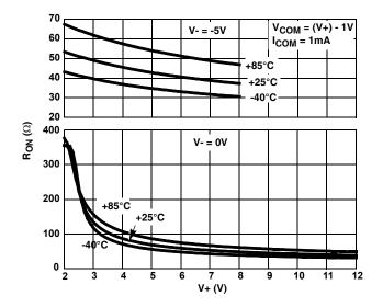
FIGURE 10. ON-RESISTANCE vs SUPPLY VOLTAGE
