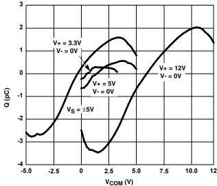
FIGURE 21. CHARGE INJECTION vs SWITCH VOLTAGE
