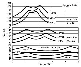
FIGURE 12. ON-RESISTANCE vs SWITCH VOLTAGE
