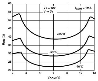
FIGURE 13. ON-RESISTANCE vs SWITCH VOLTAGE
