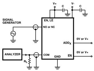
FIGURE 5. OFF ISOLATION TEST CIRCUIT
