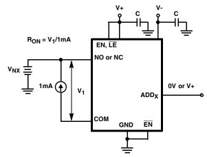
FIGURE 6. RON TEST CIRCUIT
