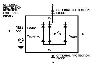
FIGURE 9. INPUT OVERVOLTAGE PROTECTION
