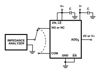
FIGURE 8. CAPACITANCE TEST CIRCUIT
