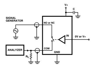
FIGURE 4. OFF ISOLATION TEST CIRCUIT
