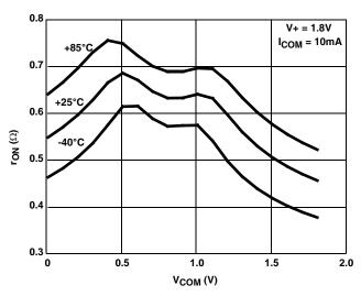
FIGURE 11. ON-RESISTANCE vs SWITCH VOLTAGE
