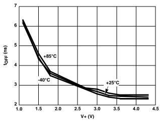
FIGURE 14. TURN-OFF TIME vs SUPPLY VOLTAGE
