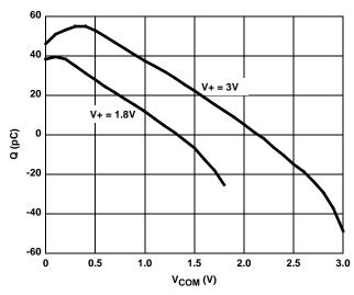
FIGURE 12. CHARGE INJECTION vs SWITCH VOLTAGE
