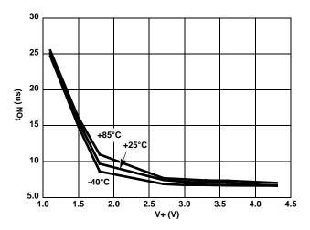
FIGURE 13. TURN-ON TIME vs SUPPLY VOLTAGE
