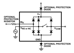
FIGURE 8. OVERVOLTAGE PROTECTION
