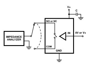
FIGURE 7. CAPACITANCE TEST CIRCUIT
