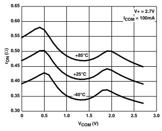
FIGURE 10. ON-RESISTANCE vs SWITCH VOLTAGE
