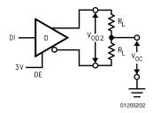
FIGURE 1. Driver  $V_{\text{OD2}}$  and  $V_{\text{OC}}$
