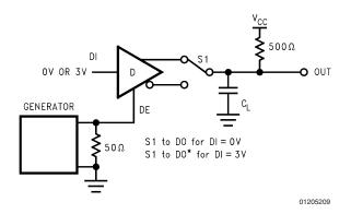
FIGURE 9. TRI-STATE Test Circuit ( $t_{\rm PZL},\,t_{\rm PLZ}$ )
