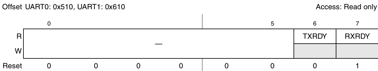
Figure 12-15. DMA Status Register (UDSR)
