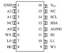
DS1807S 16-Pin SOIC (300-mil) See mech. Drawings Section
