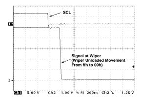
FIGURE 14. LARGE SIGNAL SETTLING TIME
