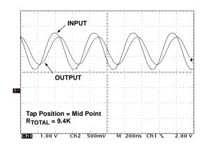
FIGURE 12. FREQUENCY RESPONSE (2.2MHz)
