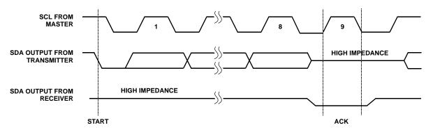
FIGURE 16. ACKNOWLEDGE RESPONSE FROM RECEIVER
