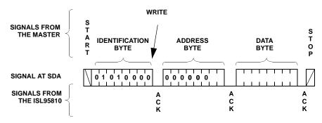
FIGURE 17. BYTE WRITE SEQUENCE
