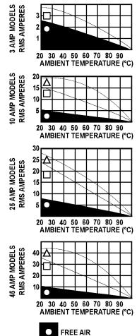
MOUNTED ON 6" X 6" PLATE (2°c/watt)
