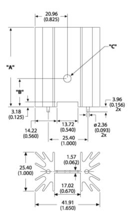
A Dim **63.50**B Dim **18.29**C Dim **3.17**
