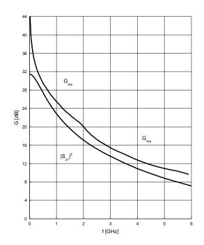
Power gain  $G_{ma}$ ,  $G_{ms} = f(V_{CE})$
