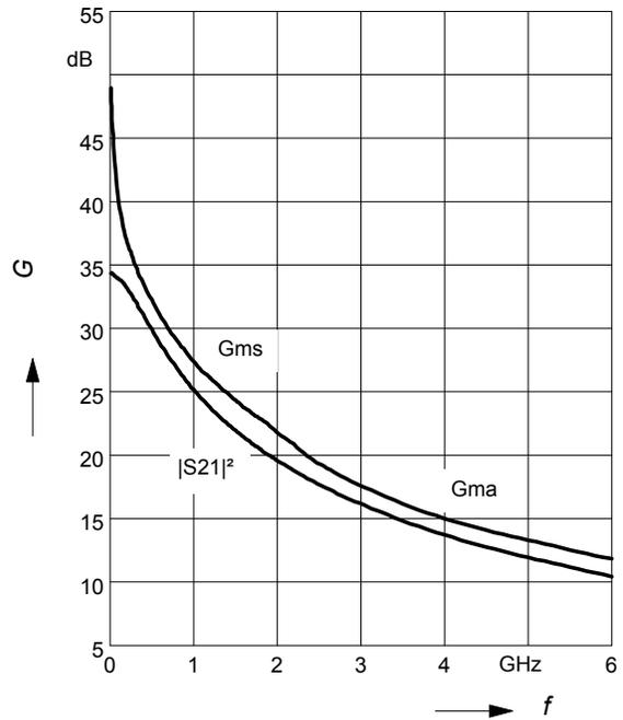
Power gain  $G_{ma}$ ,  $G_{ms} = f(V_{CE})$
