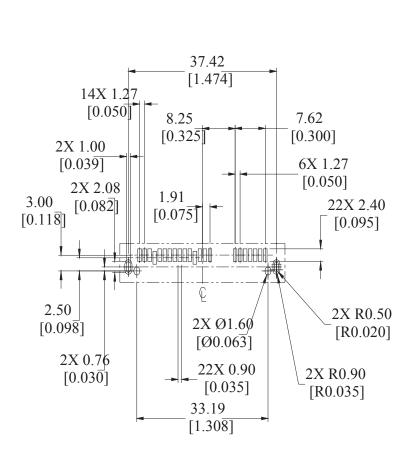
RECOMMENDED P.C.B. LAYOUT TOLERANCE :  $\pm$  0.05 [.002] TOP VIEW
