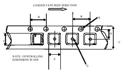
CARRIER TAPE DIMENSION FOR 14SOICN
