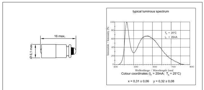
Lampensockel nach DIN EN 60061-1: S5,7s / Lamp base in accordance to DIN EN 60061-1: S5,7s
