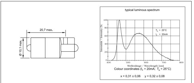
Lampensockel nach DIN EN 60061-1: W2,1 x 9,5d / Lamp base in accordance to DIN EN 60061-1: W2,1 x 9,5d
