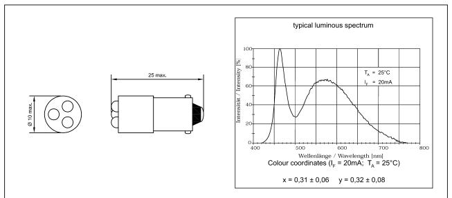
Lampensockel nach DIN EN 60061-1: BA9s / Lamp base in accordance to DIN EN 60061-1: BA9s
