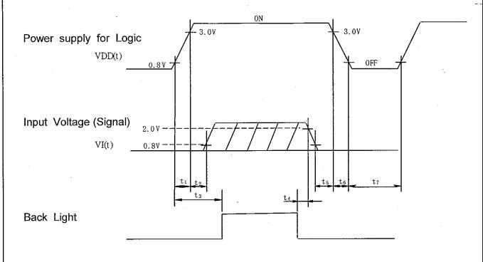
$\begin{array}{ccc} \underline{\text{POWER}} & \underline{\text{ON}} \\ & & t_1 \leq & 15\,\text{ms} \\ \\ \text{Oms} & < & t_2 \leq & 45\,\text{ms} \\ \\ \text{O. 1s} & \leq & t_3 \end{array}$
