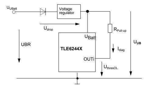
$R_{Pull-up,max} = (UBR_{min} - U_{drop,max} - U_{thresOL,max}) / I_{diag,max}$
