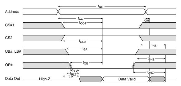
Figure 29. SRAM Read Cycle
