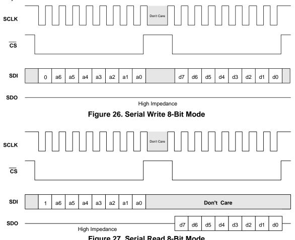
Figure 27. Serial Read 8-Bit Mode
