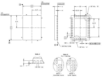
Figure 30. 38-Pin Quad Flat No-Lead Package (QFN)
