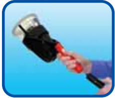
Inserte una batería entre El comprobador y el tubo
