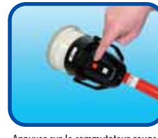
Appuyer sur le commutateur rouge pour activer. Le voyant vert s'allume. Un voyant qui clignote à intervalles lents indique un mode en VEILLE normal.
