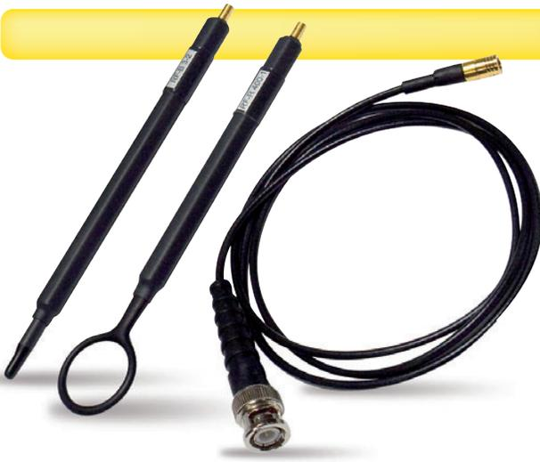
Le kit **HX0082** comprend 2 sondes de champs proche (30 MHz – 3 GHz). La sonde de proximité permet de mesurer les champs magnétiques radiofréquences. Il s'utilise jusqu'à 10 cm de la cible. La sonde de contact offre des mesures précises sur des plans de masse, ou des pistes de circuits imprimés.
