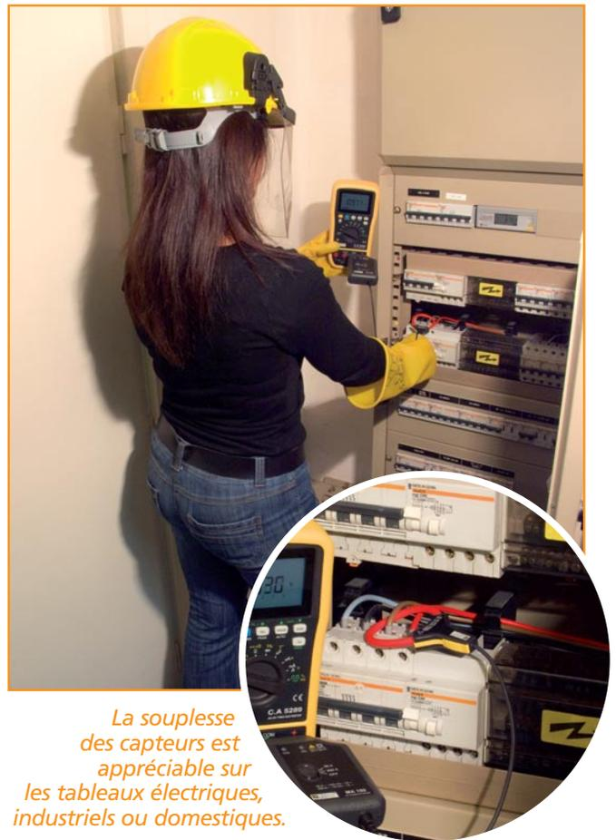
La souplesse des capteurs est appréciable sur les tableaux électriques, industriels ou domestiques.
