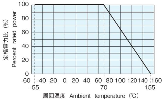
周囲温度70℃以上で使用される場合は、左図負荷軽減曲線に従って、定格電力を軽減して御使用下さい。
