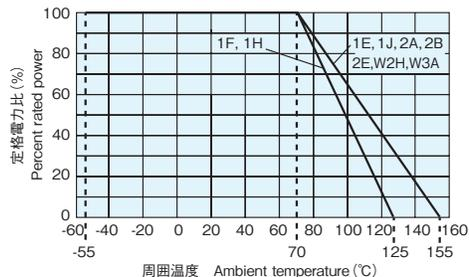
周囲温度70℃以上で使用される場合は、上図に示す負荷軽減曲線に従って、定格電力を軽減して御使用下さい。
