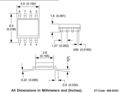
Compatible SOIC device:
