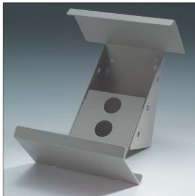
Pulthalter für Ausbau der Aluform-Gehäuse zu multifunktionellem Bedienterminal Wand- oder Tischmontage Material Stahlblech; Lackierung Pulverlack, RAL 7030, steingrau
