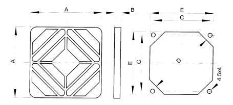
EMV-Schutzgitter für Lüftergrößen 80x80 bis 119x119mm. Diese Schutzgitter bestehen aus metallisiertem Kunststoff, silberfarben, und einem Metallnetz. Damit wird eine hohe EMV-Filterwirkung bei Frequenzen zwischen 1MHz und 1GHz bei niedrigen Kosten erreicht. Das Metallnetz muß einen direkten elektrischen Kontakt zur metallischen Oberfläche des Gerätegehäuses haben.
