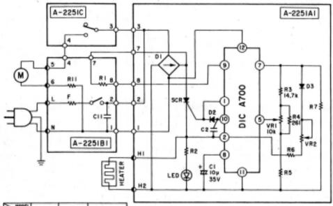
100V 120V 220~240V IW 10k IW 12k 3W 27k IW 22k IW 22k IW 51k R2 1/6W 732 1/6W 1910 1/6W 8660 220~240V ONLY 1/6W 5.6k R7 5W 100 5W 150 1.5k VR2 470 CII 220~240V ONLY 0.22p 250V 0.022 F 160V C S 0.01µ 400V
