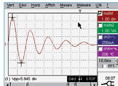
*Lorsque deux voies sont multipliées, il est possible de visualiser le résultat mis à l'échelle, avec son unité physique (W par exemple) ainsi que les courbes d'origine, ici le courant et la tension.*
