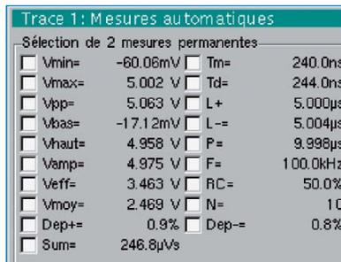
Une zone de mesure spécifique peut ensuite être sélectionnée en l'encadrant avec des curseurs manuels, pour un résultat fiable et plus précis.
