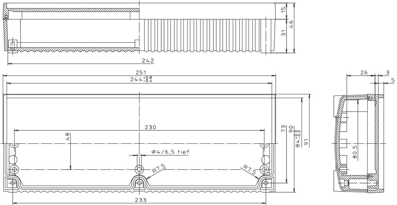
Durch Wärmeeinwirkung über längere Zeit (z.B. 75°C, 3 Std.) kann eine Nachschwindung bis 0.8% auftreten.
