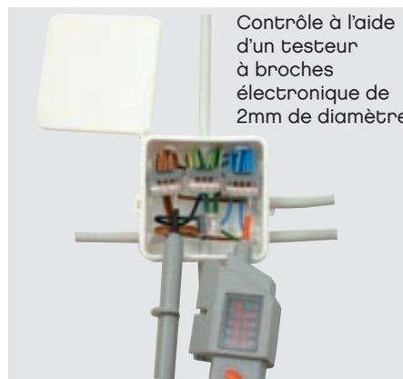
Contrôle à l'aide d'un testeur à broches électronique de 2mm de diamètre
