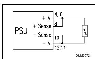
Die Senseanschlüsse werden polrichtig direkt am Netzgerät gebrückt.
