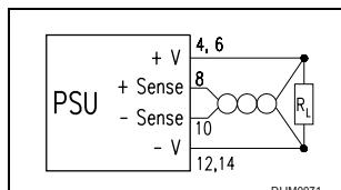
Die Fühlerleitungen werden polrichtig direkt an der Last angeschlossen. Die Leitungen müssen verdrillt oder abgeschirmt sein (Schirm mit PE verbinden). Für optimale Störspannungsunterdrückung sollte negative Ausgangsleitung mit Schutzleiter (PE, Pin 32) verbunden werden.
